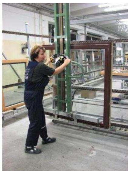
Подъемные установки (две фотографии справа) и фиксирование изделия для заключительного контроля.
