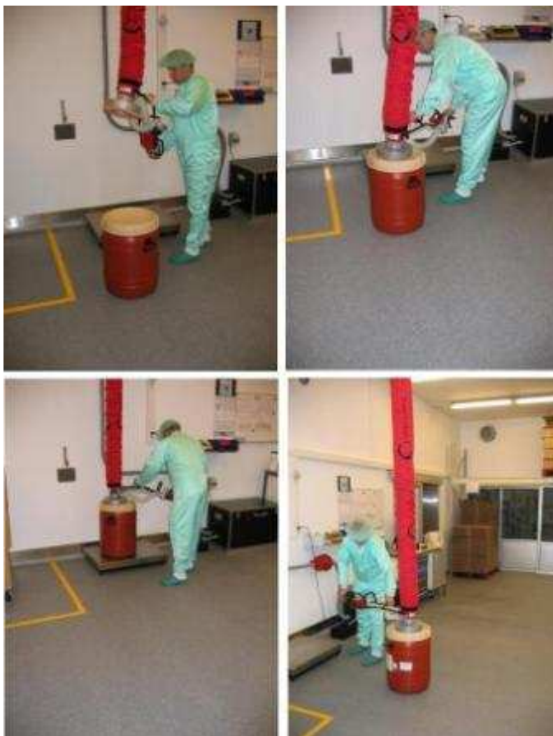
Работа с вакуумным подъемником.
