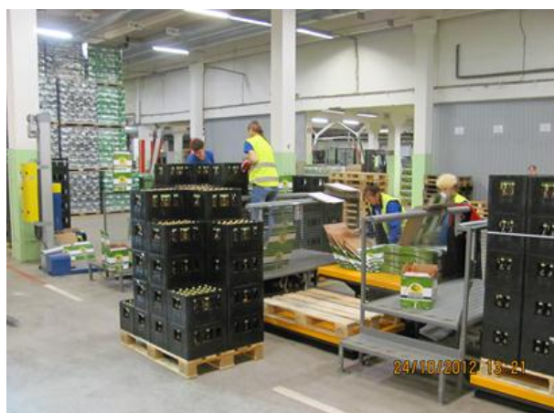
Для более удобного процесса упаковки работники имеют возможность поднять поддон с ящиками на подходящую для себя высоту.
