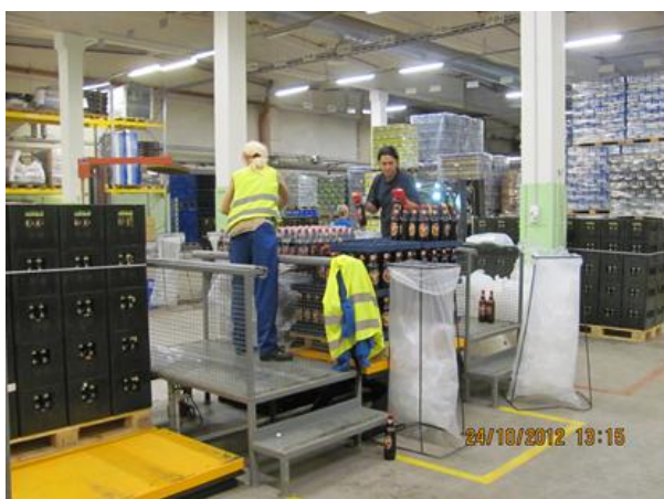
Для более удобного процесса упаковки работники имеют возможность поднять поддон с ящиками на подходящую для себя высоту.
