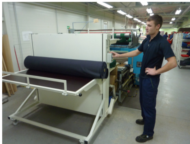
Перемещение рулона ткани на складе (слева) и укладка рулона на устройство Finn-Gonvey.
