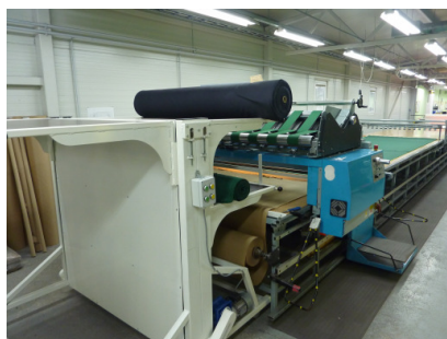
Рулон ткани укладывается на подъемный механизм и перекачивается с его помощью в подходящее место.
