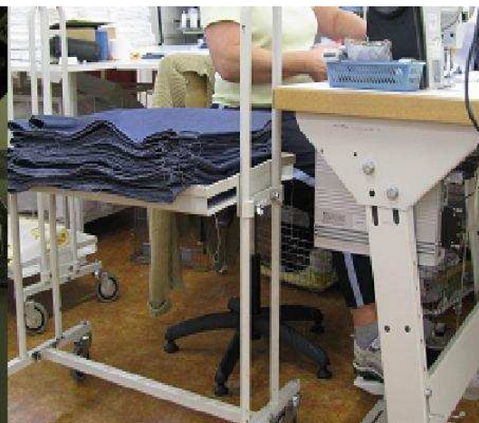
Регулируемое рабочее кресло, игольный предохранитель и тележка для складирования изделий с регулируемой высотой.
