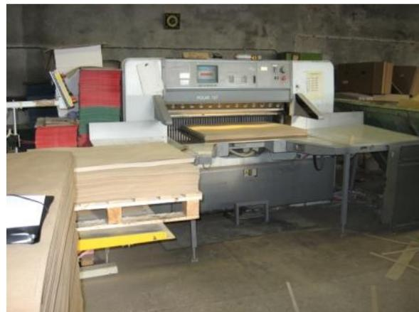
Размещенный рядом с гильотиной для бумаги подъемник помогает избежать наклонов, и повторяющихся движений.
