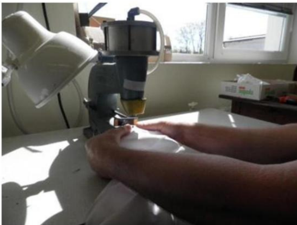
Koonuselise otsaga üles-alla liikuv silinder ülemises lähteasendis
