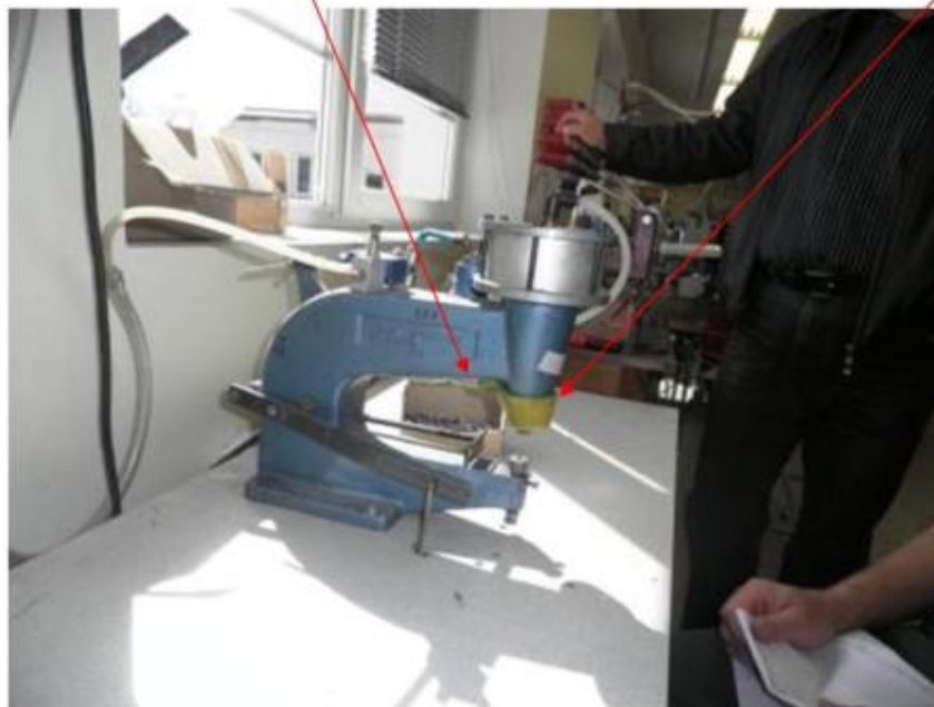
Silindri kinnitus Silinder, mis kaitseb sõrmi sattumast matriitside vahele
