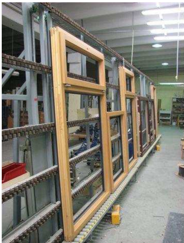
Montaažikonveier (paremal) ja muudetava kõrgusega töökoht. Fotod: Viking Window
